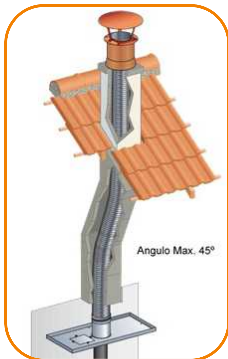
Instalação tipo de Tubo Flexível em Inox
